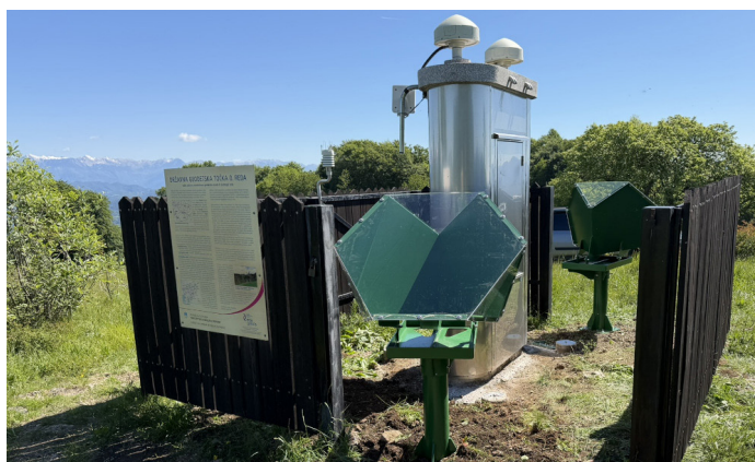
Slika 2: Kotni sipalec, nameščen ob geodetski točki 0. reda v Prilozju. (Foto: Geotočka)
