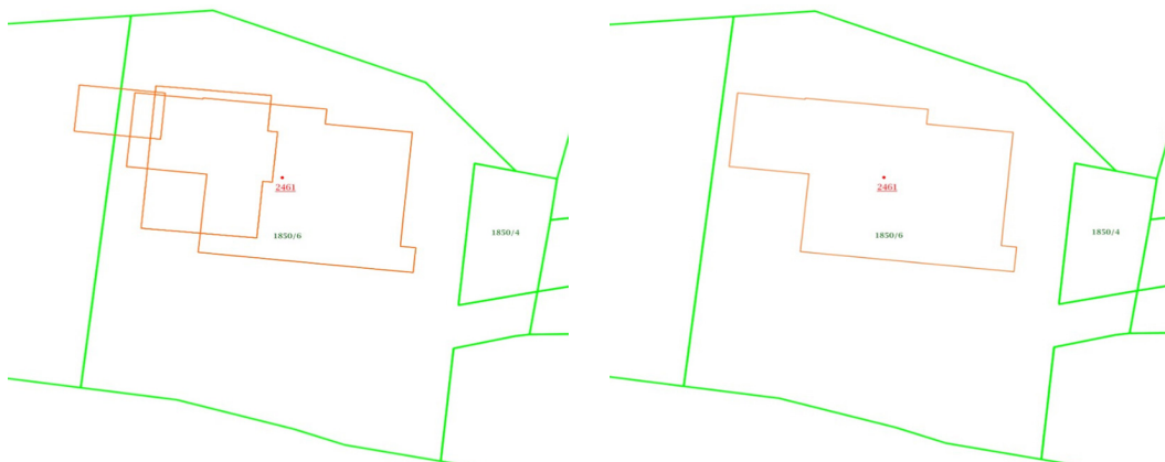
Slika 1: Primer izbrisa in vpisa stavbe v enem elaboratu: stanje pred spremembo (levo) in po spremembi (desno).
