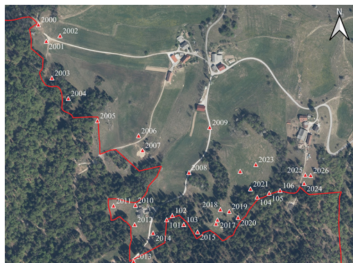
Slika 6: Prikaz poligonskih točk (100–106), določenih s tahimetrijo, in točk, določenih z izmero GNSS RTK (2000–2026).
