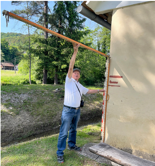
Slika 5: KT_merjenje z Dahlto010 - postavljanje late
