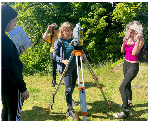
Slika 7: KT_Centriranje inštrumenta na točko brez uporabe laserja ali grezila
