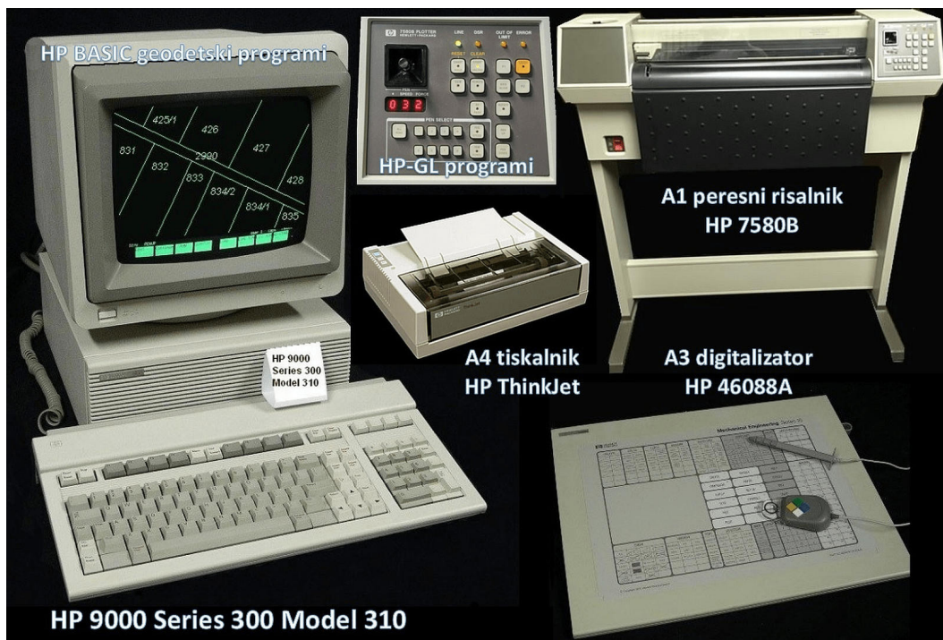
Slika 3: Računalnik HP 9000 Series 300 Model 310 s periferno opremo iz leta 1985. Programsko opremo za svoje geodetske postopke smo izdelali sami v programu HP BASIC 4.0. Slika je prirejena iz slik posameznih naprav, ki so povzete po viru HP Museum.
