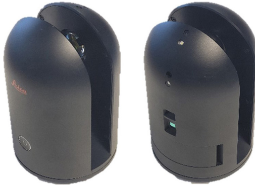
Slika 3: Instrument Leica BLK360 (vir: lastna fotografija).
