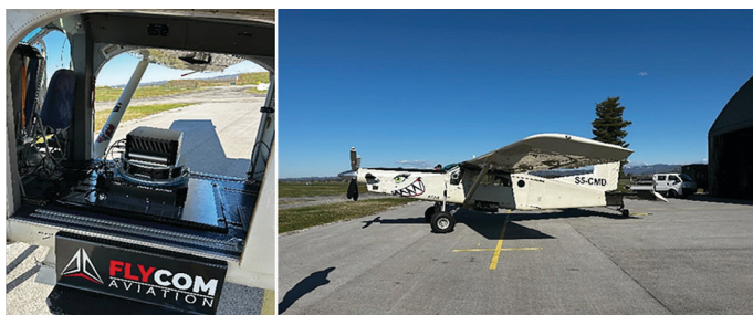
Slika 3: Levo: montaža sistema PhaseOne PAS880i (PhaseOne, 2024) v letalo; sredina: letalo Pilatus PC6 porter; desno: hkratne smeri aerofotografiranja v opisanem sistemu (vir: arhiv Flycom).
