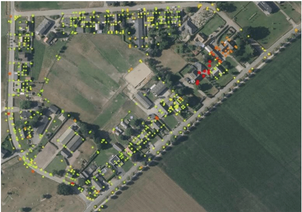
Slika 5: V gornjem delu slike je primer enajstih povezanih terenskih skic, ki tvorijo izravnano geodetsko mrežo. V spodnjem delu je prikaz izračunanih točk na ortofotu. Barva točk odraža razred njihove položajne točnosti. Povzeto po Franknu in sod. (2021).
