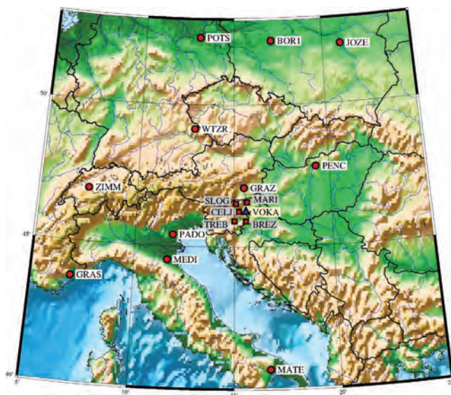
Slika 4: Stalne postaje, ki so bile uporabljene v obdelavi s programskim paketom Bernese GPS Software, Version 5.0.
