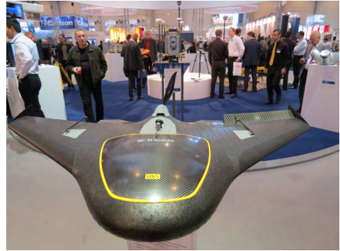
Slika 2: Trimble UX5, brezpilotno letalo (UAV) za popolno hitro in varno zbiranje podatkov iz zraka
