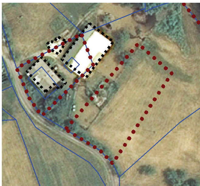
Kmetijsko gospodarstvo na Pohorju - prikaz položajnih razhajanj med parcelnimi mejami iz zemljiško katastrskega prikaza (2009), mejami stavb iz katastra stavb (2009) in mejami stavbnih zemljišč iz občinskega prostorskega planskega akta (2003) na DOF050 (GURS, 2006).
