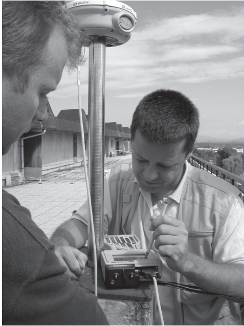
Slika 2: Testiranje instrumenta Trimble R8 GPS.
