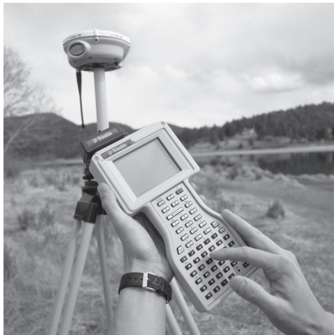
Slika 1: Testiranje instrumenta Trimble R8 GPS.
