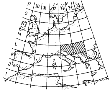
Slika 2a in b. Projekcija kartnega izreza A B C D na zemeljskem obodu v projekcijsko ravnino. Kot odmika \gamma stvarnega zemeljskega poldnevnika od projekcijske mreže je t.i. meridianska konvergenca.
