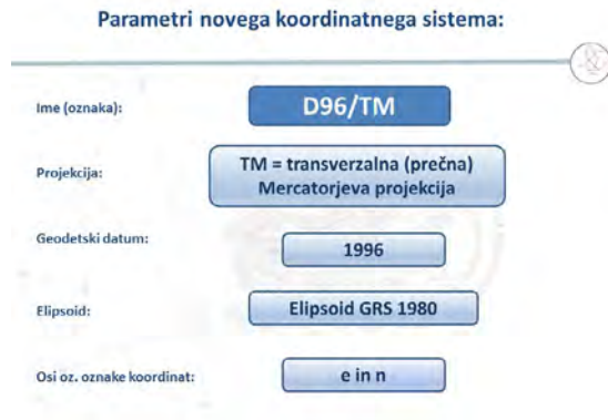
Slika 1: Parametri novega horizontalnega koordinatnega sistema D96/TM.
