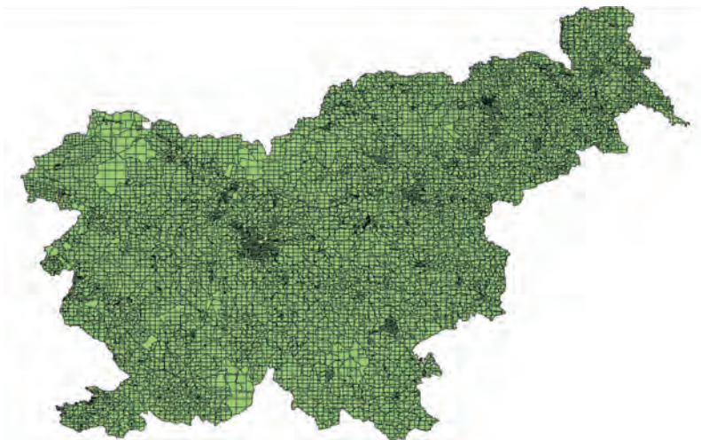
Slika 3: Shema razreza na detaljne liste zemljiškokatastrskih načrtov za vso Slovenijo, izdelana v obdobju skeniranja analognih načrtov Geodetske uprave RS. Vir: GURS, Digitalni arhiv načrtov zemljiškega katastra, 1997.
