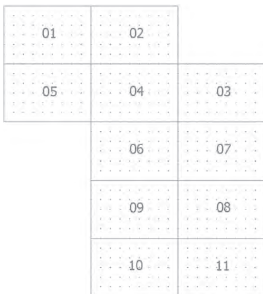
Slika 4: Primer sheme razreza na detajlne liste zemljiškokatastrskih načrtov merila 1 : 2500 z lokalno označbo detajlnih listov za k. o. 1 Hodoš. Vir: OGU Murska Sobota, 2016.
