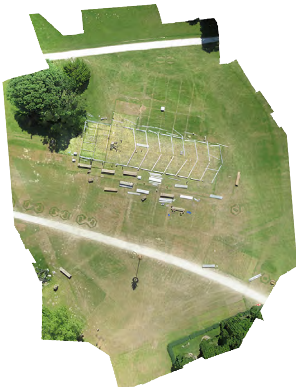
Slika 8: Ortofoto gradbišča v parku Tivoli, izdelan iz posnetkov sistema DŠGS FlyEye
