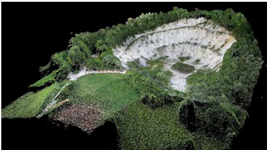
Slika 7: Oblak točk zapuščenega kamnoloma, izdelan iz posnetkov, ki so bili zajeti s sistemom DŠGS FlyEye.
