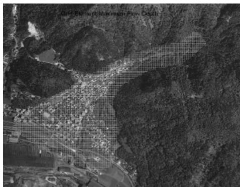
Slika 1: Računska numerična mreža 5 x 5 m (levo) in 15 x 15 m (desno) na hudourniškem vršaju Koroške Bele.
