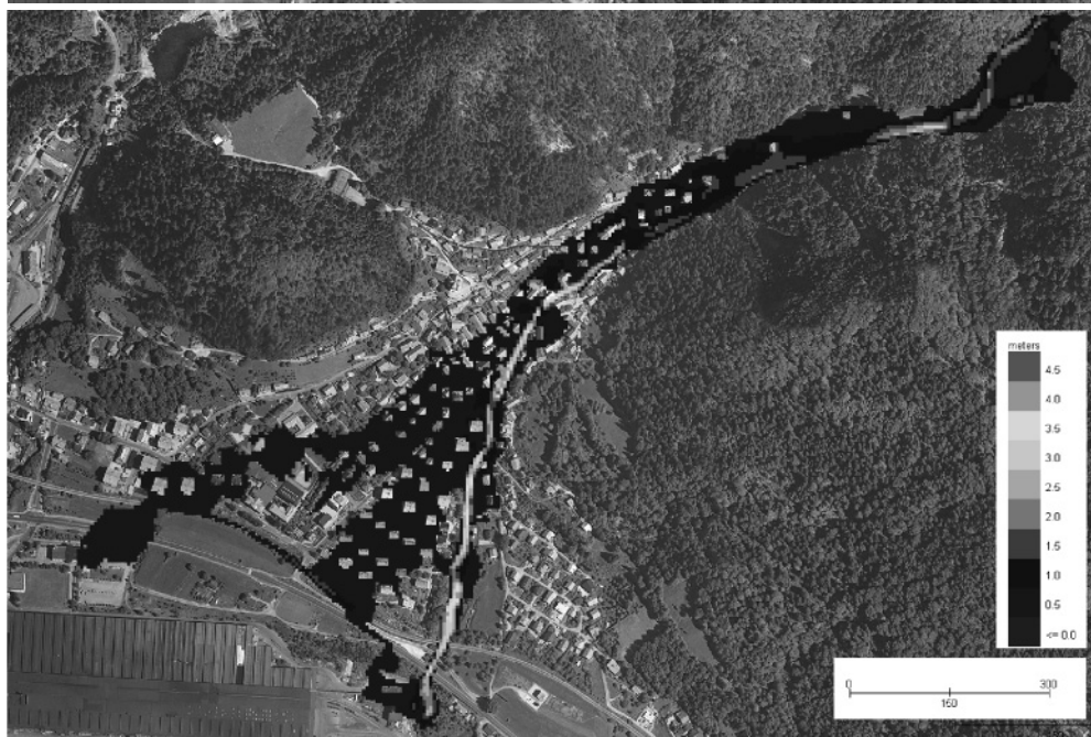
Slika 3: Rezultati modela Flo-2D za primer mokrega drobirskega toka ( C_v = 0,42 ) na vršaju Koroške Bele za numerično mrežo 5 \times 5 m (zgoraj) in 15 \times 15 m (spodaj) – vpliv zgradb je upoštevan z blokiranimi (suhimi) celicami povsod, kjer smo zgradbo prepoznali na posnetku ortofoto. Sivi toni ustrezajo največji globini toka v metrih.
